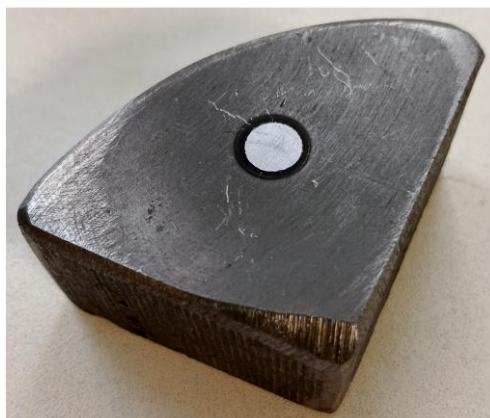
Рис. 2. Образец тантала после анализа методом МСТР
