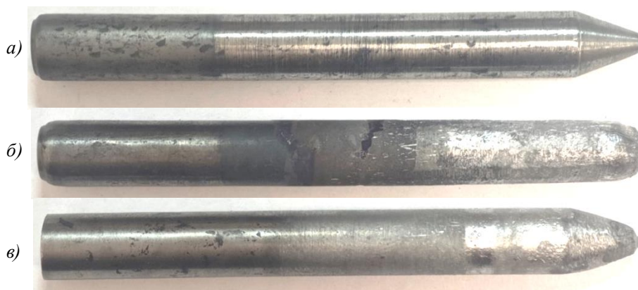
Рис. 6. Электроды в исходном состоянии перед плавкой ( а ), до ( б ) и после ( в ) отработки параметров плавки
