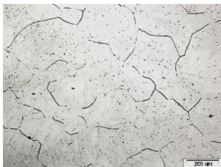
Рис. 2. Микроструктура ( \times 100 ) образца после нагрева под закалку при температуре по варианту Т5. Травление на зерно
