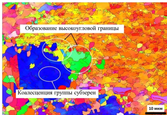
Рис. 4. Образование высокоугловой границы в экспериментальном сплаве в процессе горячей пластической деформации путем коалесценции группы субзерен
