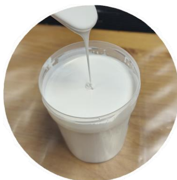
Рис. 5. Высоконаполненная фотоотверждаемая керамическая суспензия на основе оксида алюминия (51,5 % (объемн.))
