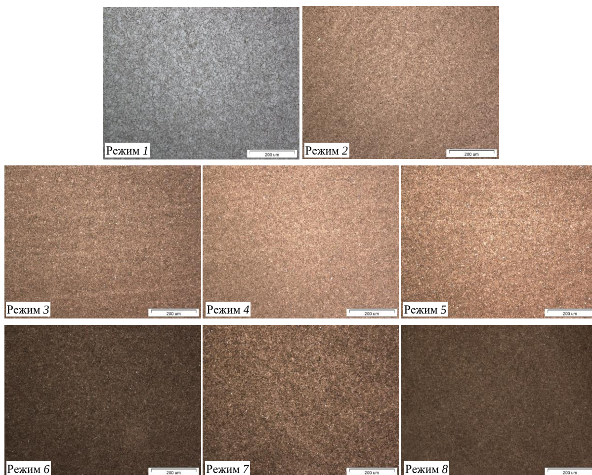
Рис. 1. Микроструктуры ( \times 200 ) высокоуглеродистой подшипниковой стали системы легирования C–Cr–Mo–W–V–Nb после различных режимов термической обработки
