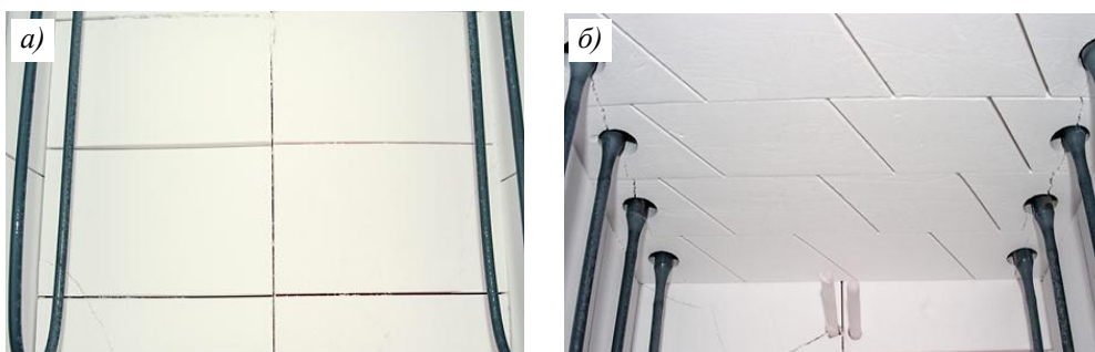
Рис. 5. Экспериментальные футеровочные материалы после термоциклирования в печи: а – задняя стенка; б – свод
