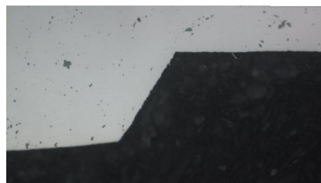
Рис. 7. Сечение прутка из плавки 1 с содержанием никеля 0,25 % и фосфора до 0,10 % после дорнирования ( \times 500 )
