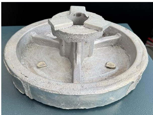
Рис. 1. Отливка заготовки корпуса из алюминиевого сплава АК9ч
