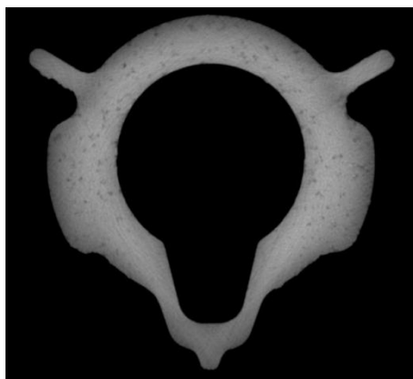
Рис. 7. Сечение фрагмента заготовки корпуса с изображением пористости
