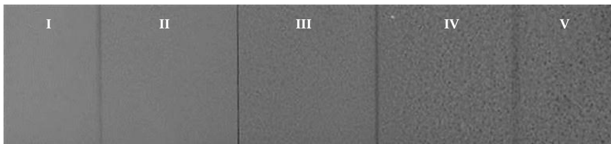
Рис. 8. Рентгенограмма эталонных образцов толщиной 5 мм из сплава АК7пч (АЛ9-1) с газовой пористостью с I по V балл
