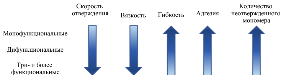
Рис. 5. Характерное изменение свойств образующегося сополимера в зависимости от функциональности акрилатных разбавителей
