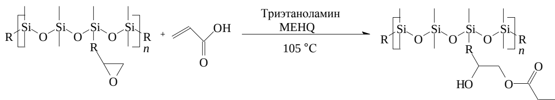
Рис. 14. Схема модификации эпоксиполиорганосилоксана акриловой кислотой
