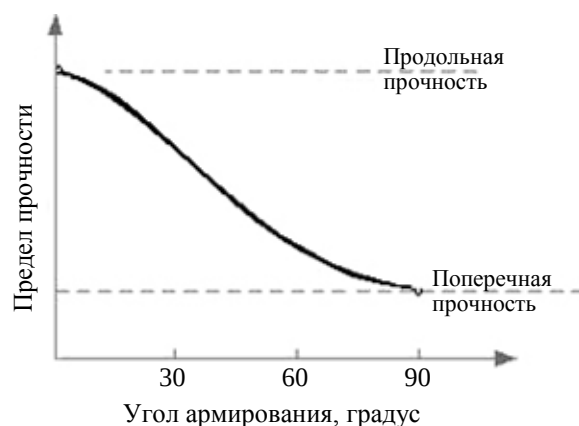
Рис. 6. Зависимость прочности при растяжении полимерного композиционного материала от угла ориентации армирующего наполнителя
