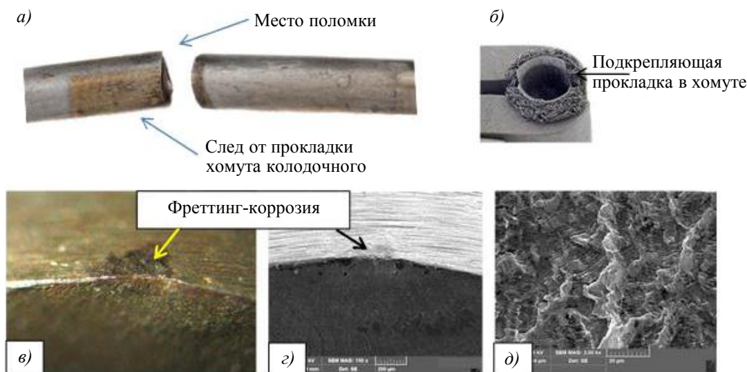
Рис. 1. Фреттинг-коррозия на поверхности трубы (а, в, д) и вид излома (з, д) по направлению усталостной трещины, образовавшейся при контакте с хомутом (б)
