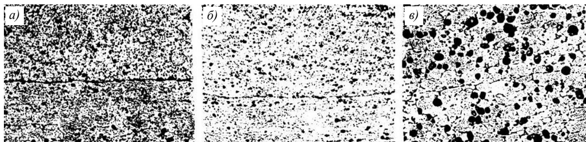
Рис. 1. Структура материала в зоне сварного соединения алюминия (а, б) и титана (е) [11]
