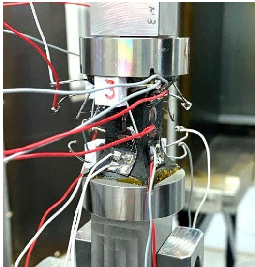
Рис. 9. Вид образца, подготовленного к определению физико-механических параметров
