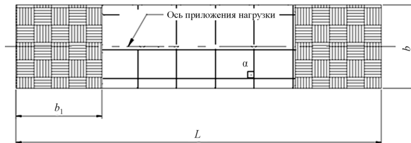
Рис. 3. Схематичное изображение образца углепластика с ортогональной укладкой: \alpha – угол ориентации армирующего наполнителя, L – длина образца, b – ширина образца, b_1 – длина зоны зажима
