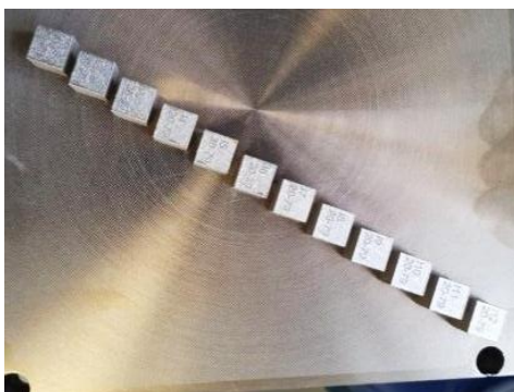
Рис. 2. Кубики, синтезированные по разработанной сетке режимов
