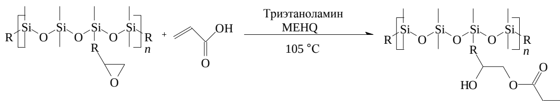
Рис. 14. Схема модификации эпоксиполиорганосилоксана акриловой кислотой
