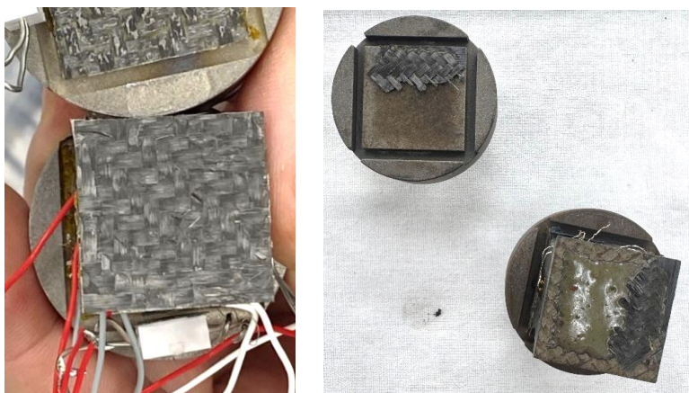
Рис. 7. Вид разрушения образцов, которые подвергались механической обработке
