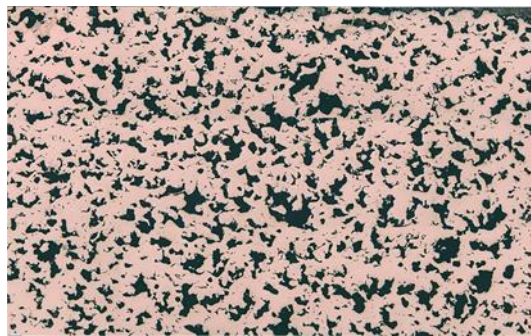
Рис. 4. Панорамный снимок ( \times 50 ) МКМ с порами
