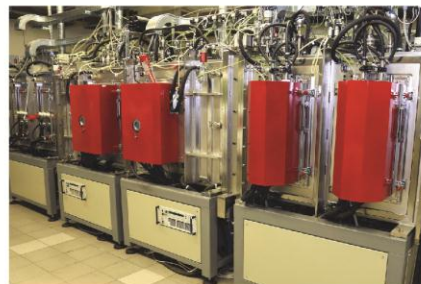
Установка среднечастотного магнетронного напыления УОКС-3
