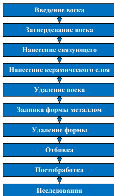
Рис. 2. Схема процесса изготовления отливок из титановых сплавов
