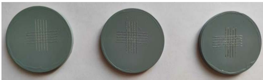
Рис. 6. Образцы из магниевых сплавов после испытаний на адгезию
