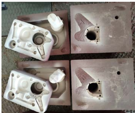
Рис. 1. Верхние и нижние полуформы отливки «Корпус» со стержнями
