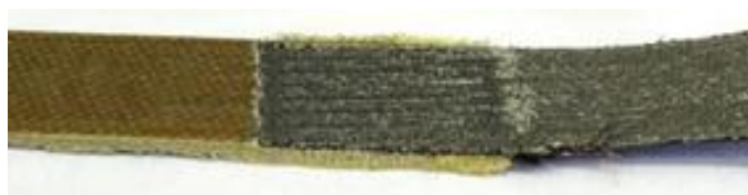
Рис. 7. Фрагмент образца для испытаний на прочность при сдвиге, имитирующего ремонтные процедуры [17]
