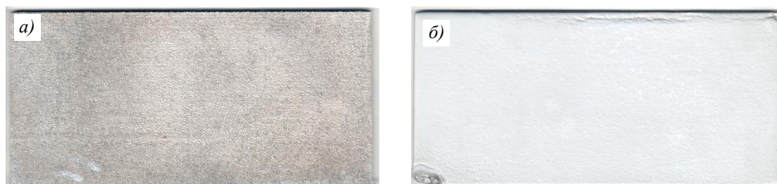
Рис. 2. Внешний вид образца в виде пластины до (а) и после (б) электролитно-плазменного полирования при напряжении между электродами 260 В. На образце после обработки оплавился угол в месте контакта образца с подвесом
