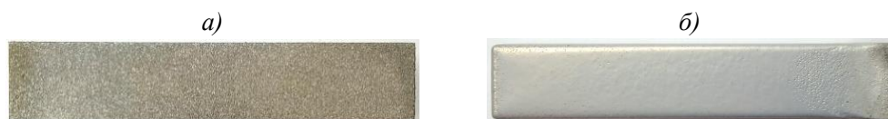
Рис. 1. Внешний вид образца до (а) и после (б) электролитно-плазменного полирования в растворе с добавкой лимонной кислоты (продолжительность обработки 30 мин)
