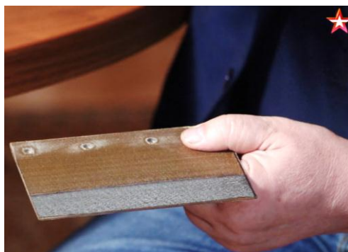
Рис. 3. Гибкий элемент из арамидного органопластика с нанесенным антифрикционным покрытием [18]
