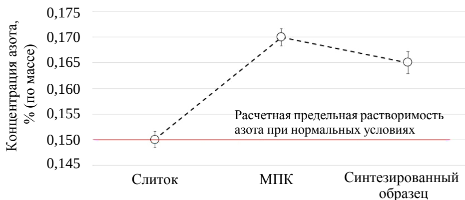
Рис. 5. Изменение концентрации азота в высокоазотистой коррозионностойкой подшипниковой стали системы легирования Fe–Cr–Mo–Ni–V–C–N на различных этапах (МПК – металлпорошковая композиция)
