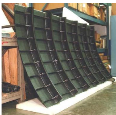
Рис. 8. Стрингерная панель из полимерных композиционных материалов на основе полиимидного связующего LaRC PETI-5 и углеродного волокна IM7 [30]
