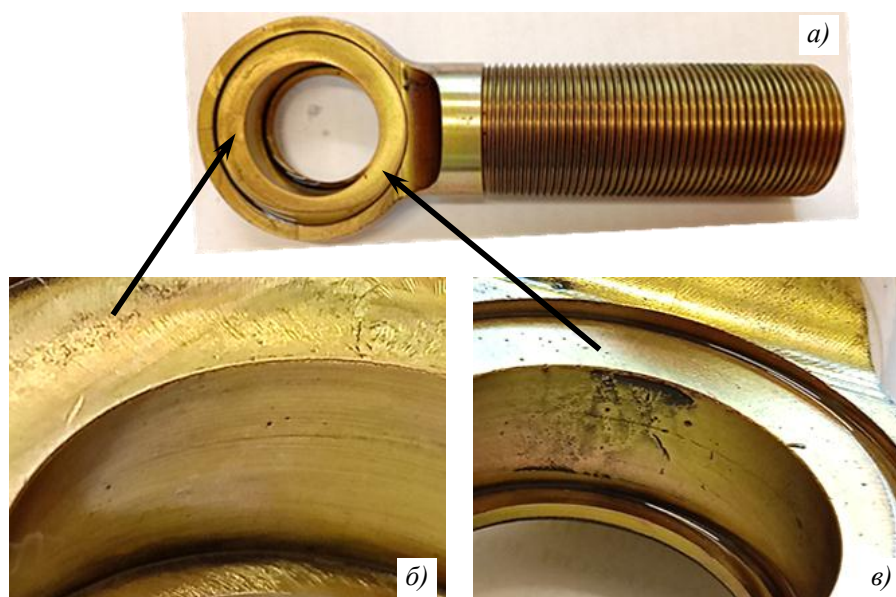
Рис. 4. Внешний вид детали (а) и места отложения магнитного порошка (б, в). Стрелками указаны диаметрально расположенные зоны, в которых обнаружены отложения в виде линий
