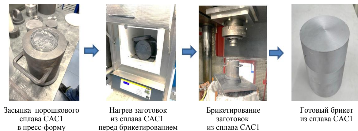
Рис. 3. Технологический процесс компактирования заготовок из сплава САС1
