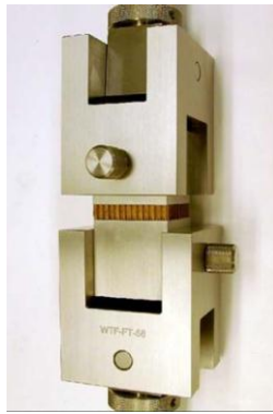
Рис. 7. Растяжение сотового заполнителя с помощью наклеенных блоков
