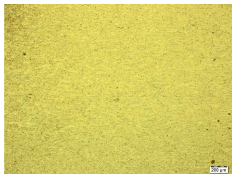
Рис. 4. Микроструктура ( \times 50 ) основного материала
