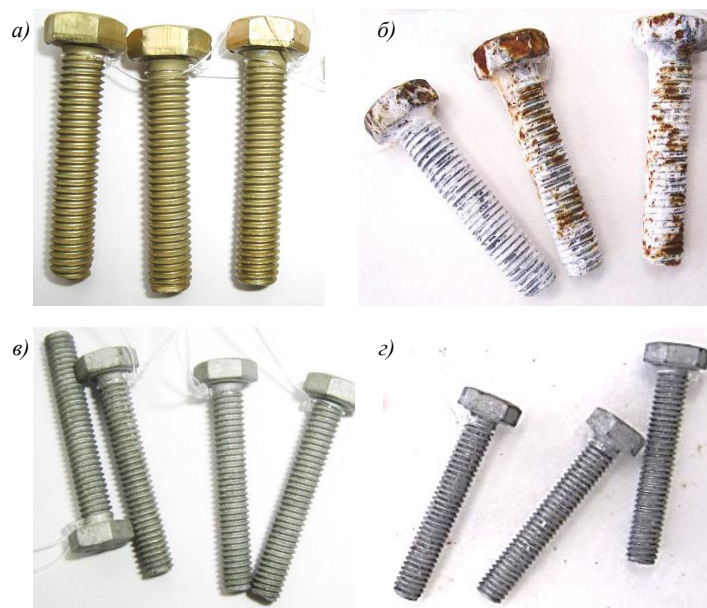
Рис. 4. Стальные болты с защитными гальваническими (а, б) и термодиффузионными (в, з) цинковыми покрытиями в исходном состоянии (а, в) и после экспозиции в камере солевого тумана в течение 2000 ч (б, з)
