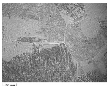
Рис. 2. Микроструктура образцов от штамповок из сплава ВТ6ч после режимов термической обработки с нагревом в \beta -область с различной температурой второй ступени (поперечное сечение)
