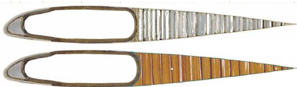
Рис. 1. Пример сечения существующих лопастей несущего винта (I–III этап развития конструктивно-силовых схем)
