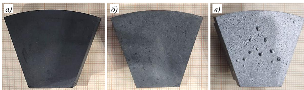
Рис. 1. Внешний вид заготовки типа 1 после прессования (а), карбонизации (б) и силицирования (в)
