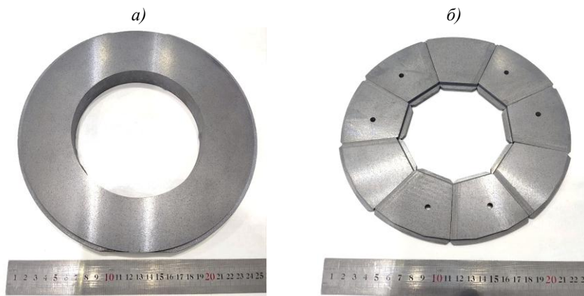
Рис. 4. Внешний вид механически обработанных силицированных изделий типа 3 (а), 1 и 2 (б)
