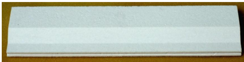
Рис. 2. Керамический образец с щелевым соплом
