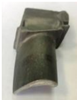
Рис. 6. Отливка лопатки, содержащая керамический стержень из плавленного кварца
