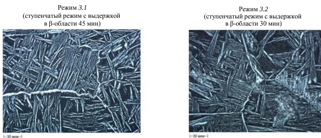
Рис. 2. Микроструктура заготовок из титанового сплава BT22M после ступенчатой термической обработки (по режиму 3) с различной продолжительностью выдержки в \beta -области
