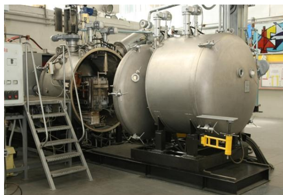
Рис. 14. Промышленная печь УВНС-6 (с жидкометаллическим охладителем – расплавом олова) со шлюзовой камерой
