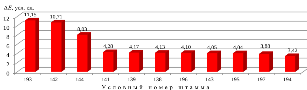
Рис. 2. Цветовое различие \Delta E лакокрасочного покрытия ВЭ-69 с красным пигментом после 90 сут воздействия монокультур грибов по методу 2
