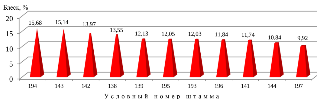
Рис. 13. Изменение блеска лакокрасочного покрытия ЭП-140 с красным пигментом после 45 сут воздействия монокультур грибов по методу 1
