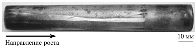
Рис. 2. Отливка образца с макросегрегацией, полученная методом направленной кристаллизации с плоским фронтом роста первичного сплава Ni–11Al–3Re–3Ru
