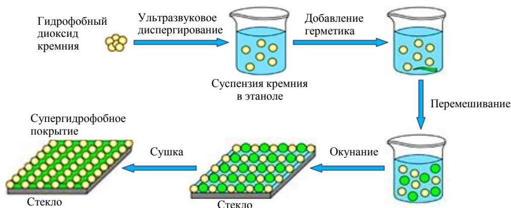
Рис. 2. Схема приготовления супергидрофобного покрытия
