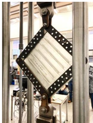
Рис. 3. Проведение испытаний сварных стрингерных панелей фюзеляжа
