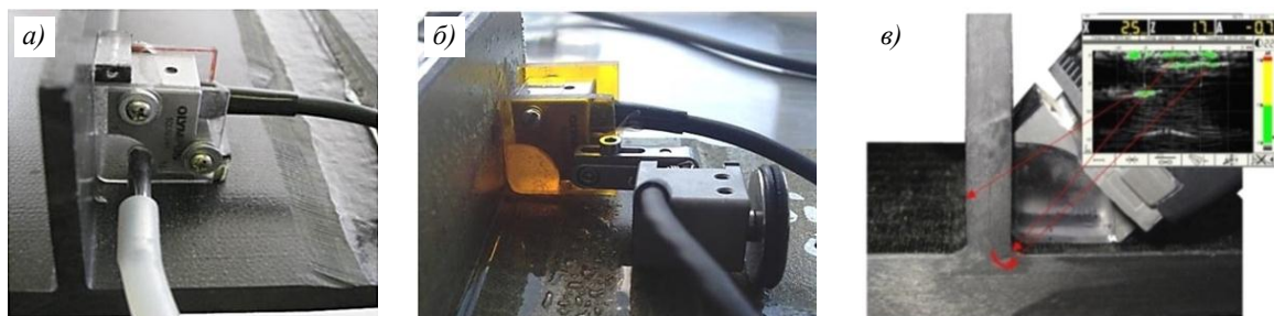
Рис. 4. Контроль радиусными фазированными решетками с помощью локальной иммерсионной ванны (а) либо призм из аквалена (б) или полистирола (в)
