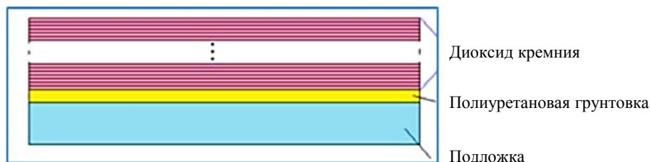
Рис. 1. Схематическая структура покрытия, полученного многостадийным методом
