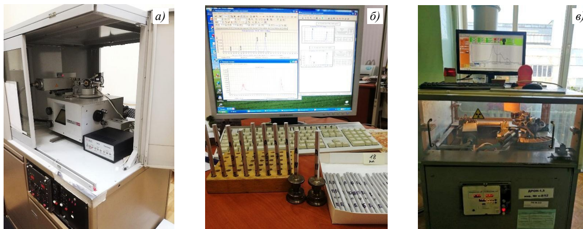
Рис. 5. Дифрактометр ДРОН-4 (а) с микропроцессорной системой автоматизации МСПАРД (б) и автоматизированный дифрактометр ДРОН-1,5 (в) с системой автоматизации для контроля затравок «Разбраковщик»
