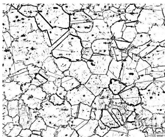
Рис. 4. Микроструктура ( \times 100 ; увеличено при печати) сплава марки ВЖ176 после отжига при температуре 960 °С в течение 1 ч (изображение обработано в программе NEXSYS ImageExpert Pro 3.6)
