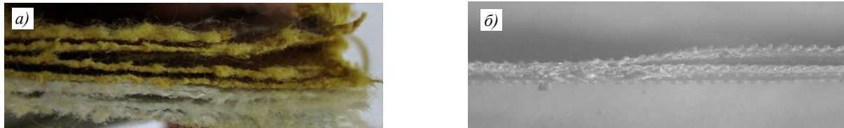
Рис. 4. Примеры дефектов: а – расслоение, б – трещина [18]
