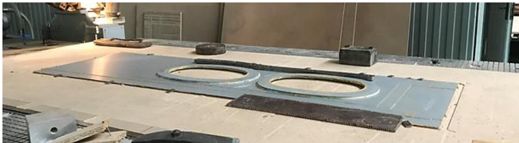
Рис. 1. Формообразованный фрагмент нижней обшивки панели крыла из металлополимерного композиционного материала
