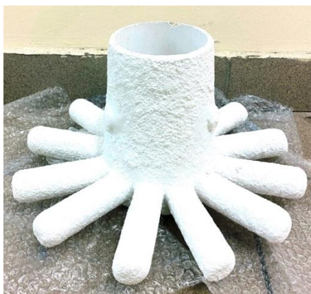
Рис. 2. Внешний вид керамической формы для литья образцов
