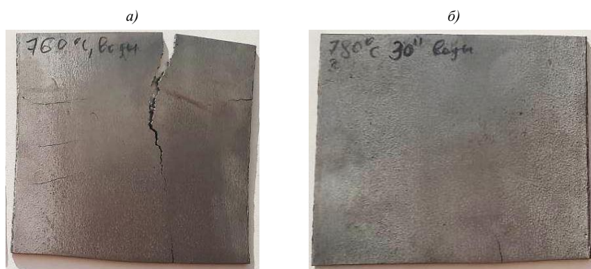
Рис. 2. Внешний вид образцов из сплава Fe–Cr–Al–Y после холодной прокатки: закалка при температуре 760 (а) и 780 °С (б), выдержка 30 мин, охлаждение в воде. Степень деформации \varepsilon составила 10 (а) и 7 % (б)
