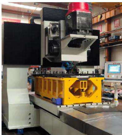
Рис. 1. Установка для сварки трением с перемешиванием FSW-LM-AF25-AB
