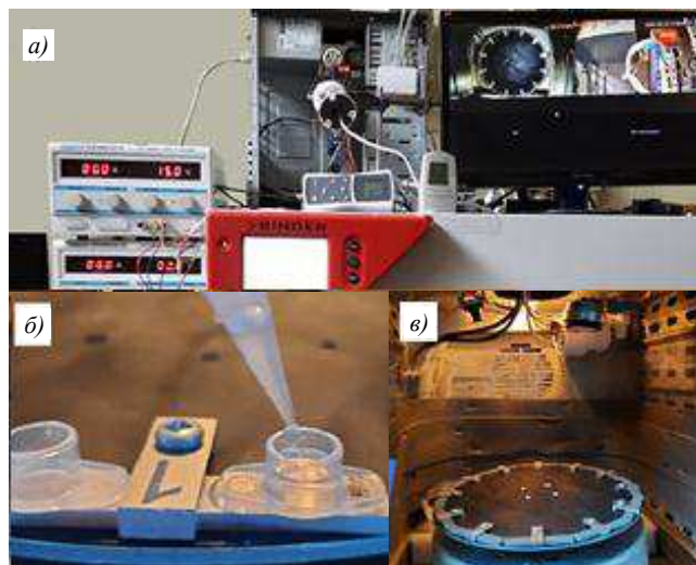
Рис. 8. Центробежная установка для определения адгезии льда методом центробежной силы: а – общий вид; б – заполнение втулки водой; в – вид на рабочее пространство климатической камеры
