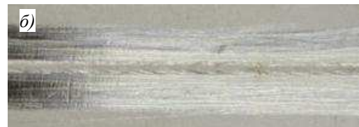
Рис. 3. Внешний вид сварных соединений из сплавов В-1213 (а) и 1151 (б), выполненных лазерной сваркой
