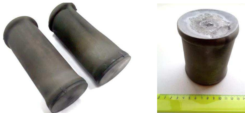
Рис. 1. Капсулы для компактирования гранул из сплава ВЖ172 после горячего изостатического прессования
