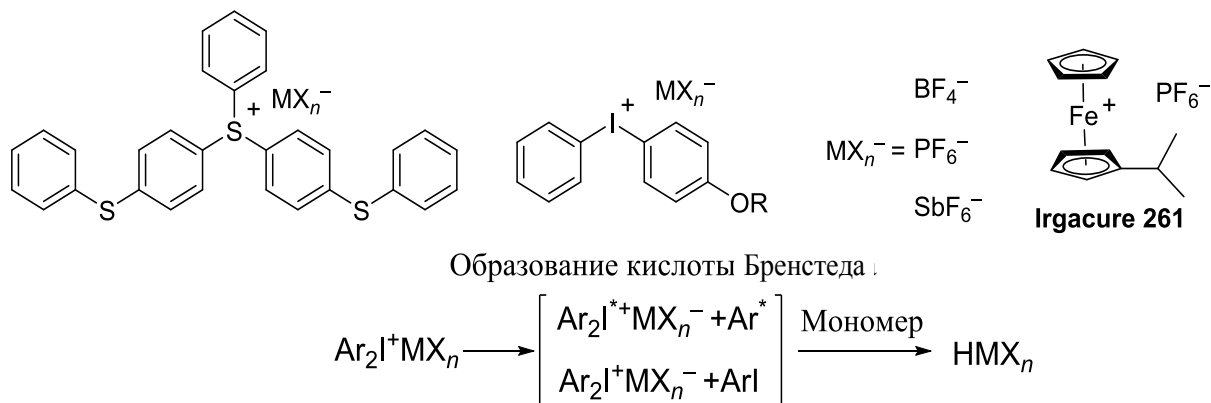
Рис. 6. Химические структуры катионных фотоинициаторов и схема получения кислоты Бренстеда
