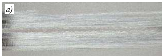
Рис. 3. Внешний вид сварных соединений из сплавов В-1213 (а) и 1151 (б), выполненных лазерной сваркой
