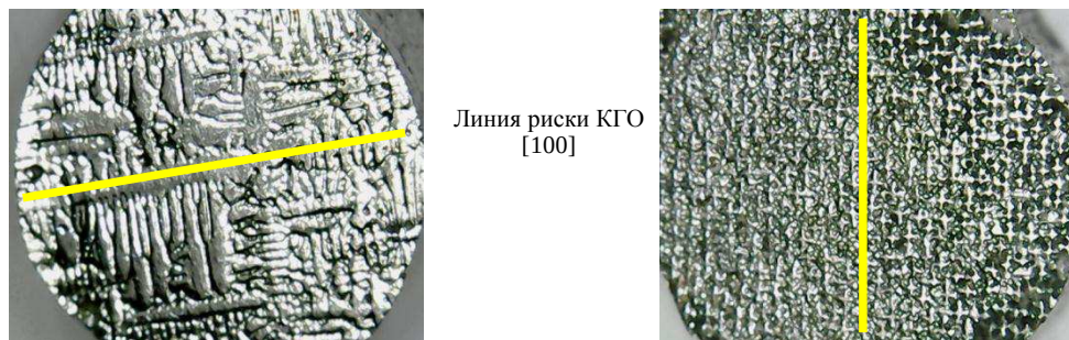
Рис. 8. Затравки с указанным направлением КГО [100]
