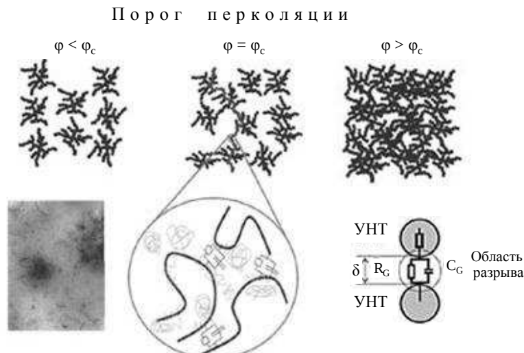
Рис. 3. Формирование электропроводящей сетки при различных концентрациях углеродных нанотрубок (УНТ)
