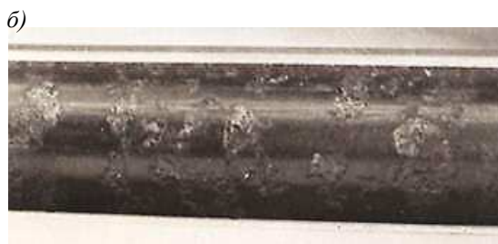
Рис. 6. Коррозия вала трансмиссии закрылков гражданского пассажирского самолета, разработанного в ОКБ А.Н. Туполева: наконечника (а) и трубы (б) из вороненой и загрунтованной стали 30ХГСА
