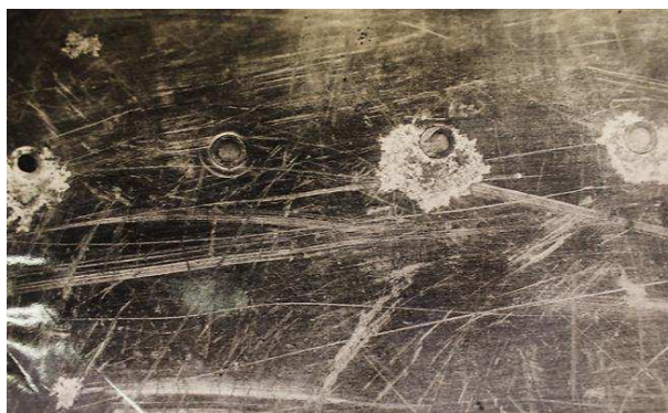
Рис. 12. Коррозия днища лодки гидросамолета, созданного на ТАНТК им. Г.М. Бериева, после стоянки в акватории Баренцева моря
