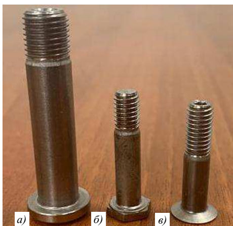
Рис. 2. Внешний вид болтов из псевдо-β-титанового сплава BT47, изготовленных в промышленных условиях АО «Нормаль» с плоско-скругленной головкой и короткой резьбовой частью типа Hi-Lok M10 (а), с уменьшенной шестигранной головкой для соединений со специальной переходной посадкой M6 (б) и с потайной головкой с углом 120 градусов типа Hi-Lok M6 (в)
