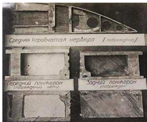
Рис. 1. Микологические повреждения центроплана крыла многоцелевого одномоторного самолета, созданного в ОКБ Н.Н. Поликарпова
