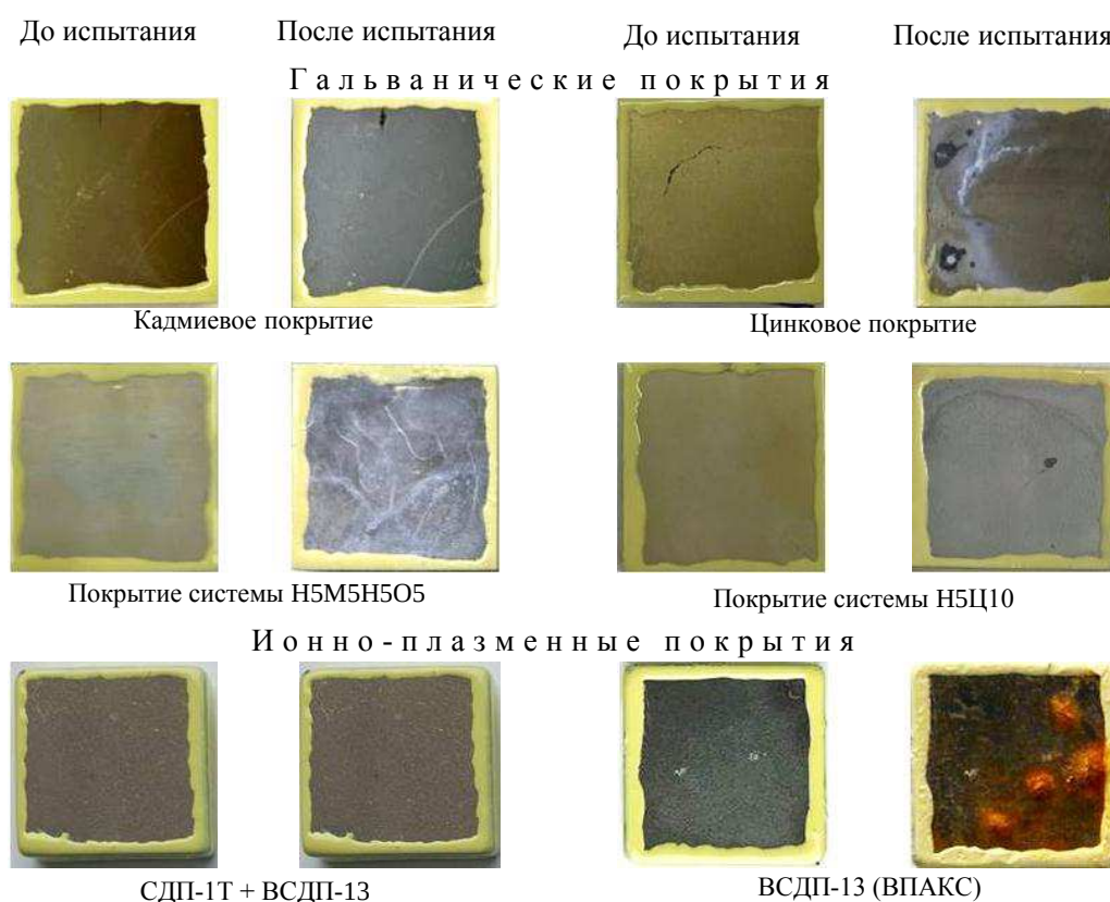
Рис. 3. Внешний вид образцов магнитов системы Nd–Fe–В с противокоррозионными покрытиями до и после 720 ч испытаний в камере солевого тумана
