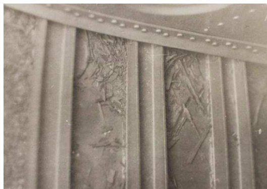
Рис. 8. Панель стабилизатора самолета, разработанного в ОКБ «Антонов», с отслоившимися валиками клея
