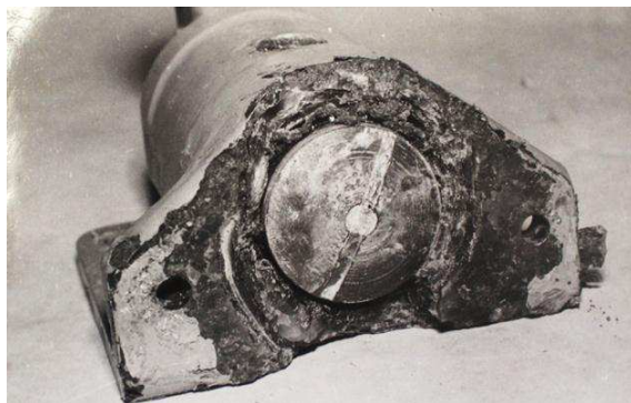
Рис. 9. Коррозия литого узла из-под пола фюзеляжа из сплава МЛ5-Т4 тяжелого военно-транспортного самолета, разработанный в ОКБ С.В. Ильюшина
