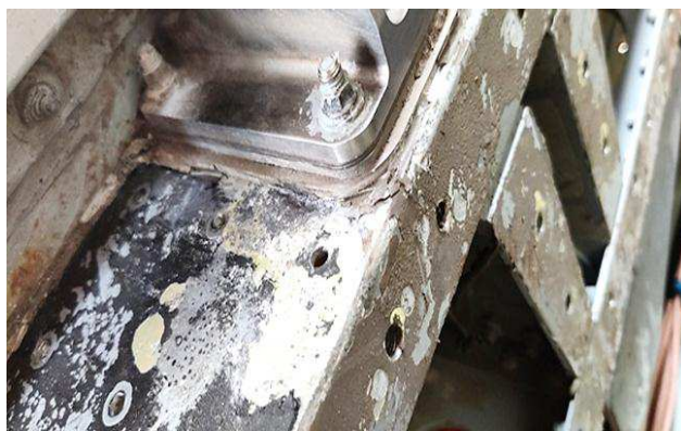
Рис. 20. Контактная коррозия алюминиевой детали
