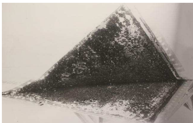
Рис. 17. Разрушение сотового клееного элерона самолета, разработанного в ОКБ А.И. Микояна
