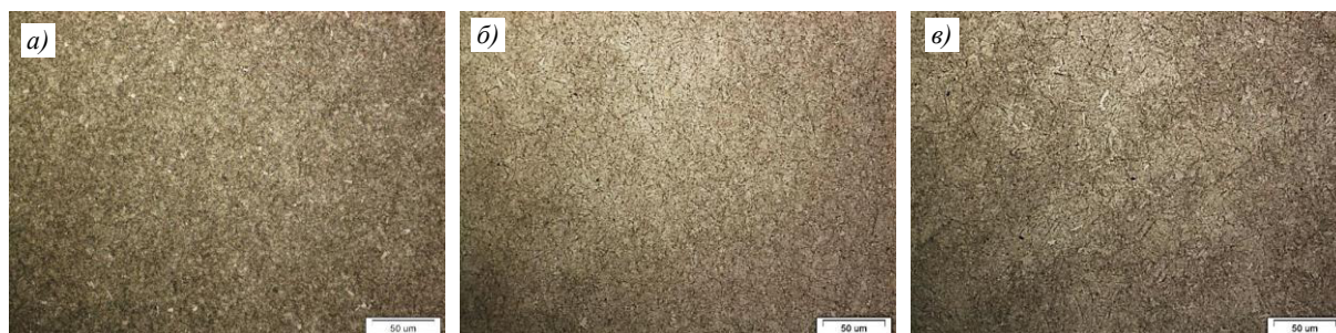
Рис. 1. Микроструктура образцов из теплостойкой подшипниковой стали с мелко- (а), средне- (б) и крупноигольчатым мартенситом (в) после упрочняющей термической обработки
