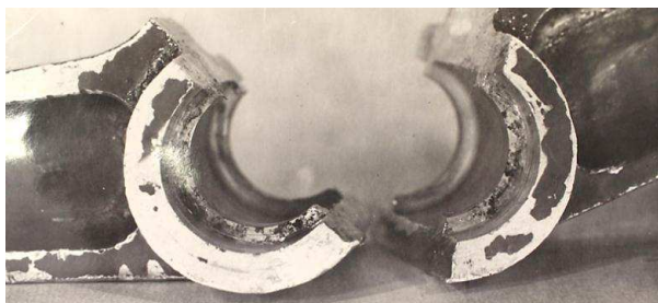
Рис. 13. Коррозия кронштейна из сплава АК8 в контакте с подшипниками из стали Х18 (через грунт) гидросамолета, разработанного на ТАНТК им. Г.М. Бериева
