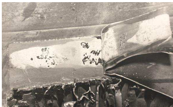
Рис. 19. Нарушение клеевых соединений в лопастях несущего винта вертолета, разработанного в ОКБ М.Л. Миля
