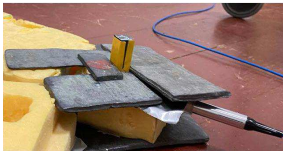
Рис. 3. Фотография образцов с ионизационной камерой
