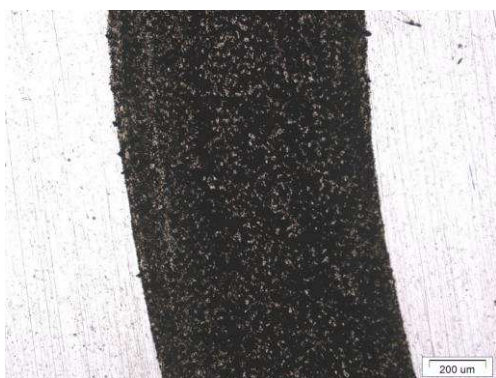
Рис. 7. Вид дорожки износа ( \times 100 ) после испытания на изнашивание в условиях сухого трения скольжения стали ВНС32-ВИ в паре трения с оксидной керамикой ZrO_2
