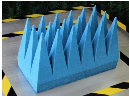
Рис. 1. Пирамидальный радиопоглощающий материал марки «Мох», разработанный в ООО НПП «Радиострим»
