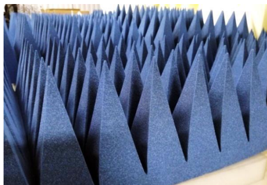
Рис. 2. Пирамидальный радиопоглощающий материал серии AMP, разработанный в ООО НПК «ТЕСАРТ»
