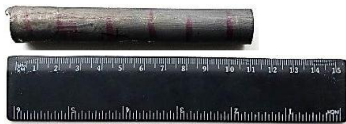
Рис. 2. Монокристаллическая отливка из литейного интерметаллидного сплава на основе соединения \text{Ni}_3\text{Al} , полученная на установке УВНС-5 методом высокоградиентной направленной кристаллизации
