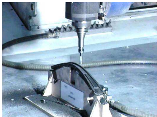
Рис. 4. Приспособление для изготовления детали из ПКМ, имеющей сложную форму профиля
