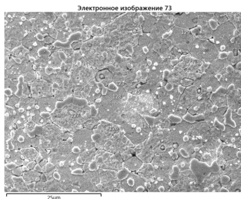
Рис. 2. Участки энергодисперсионного анализа образца из сплава системы Mo–Ti–Zr–C после компактирования при температуре 1550 °C
