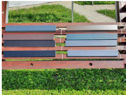
Рис. 1. Экспозиция образцов ПВХ-профиля в ГЦКИ ВИАМ
