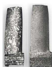
Лопатка, полученная без модификатора (А) и с модификатором (Б)
