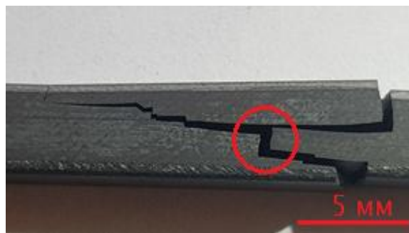
Рис. 3. Характер излома образца многослойного ККМ
