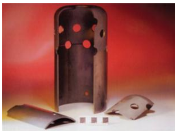
Рис. 1. Камера сгорания, изготовленная из SiC-материала с многослойной структурой
