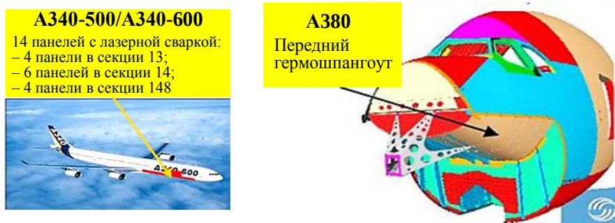
Рис. 4. Применение панелей, выполненных лазерной сваркой, в конструкциях современных самолетов компании Airbus
