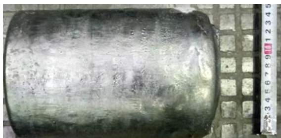
Рис. 3. Внешний вид выплавленного в печи ДЭШП-0,1 слитка экспериментальной стали 10X3A диаметром 130 мм
