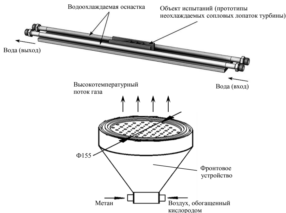
Рис. 1. Схема экспериментальной установки для испытаний прототипа неохлаждаемой сопловой лопатки турбины из ККМ
