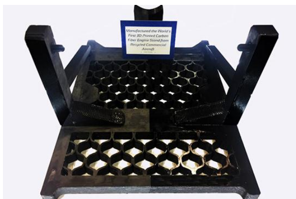
Рис. 3. Стенд двигателя, изготовленный из переработанного углеродного волокна [21]
