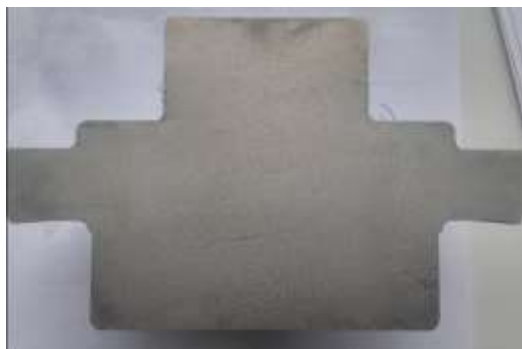
Рис. 5. Макроструктура заготовки диска из сплава в деформированном состоянии
