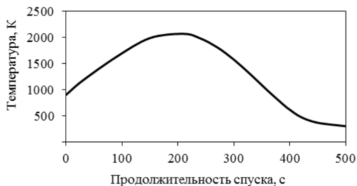
Рис. 2. Модельная зависимость температуры в критической точке аппарата от продолжительности спуска
