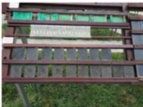
Рис. 8. Стенд с образцами в условиях умеренного теплого климата
