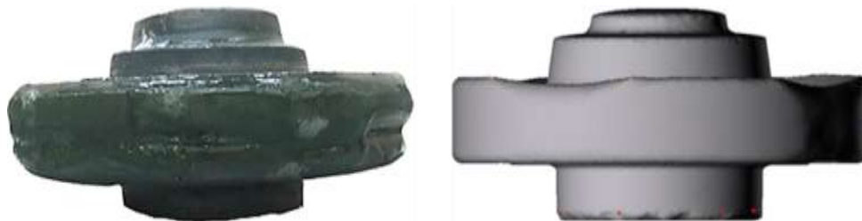
Рис. 6. Внешний вид штамповки, полученной в процессе реальной штамповки (а) и компьютерного моделирования (б)
