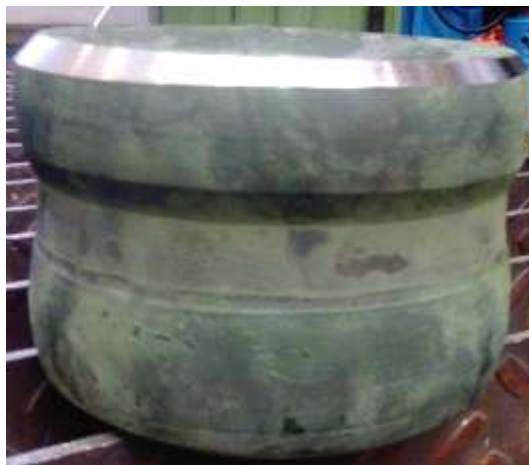
Рис. 4. Заготовка диска после подпрессовки в контейнере
