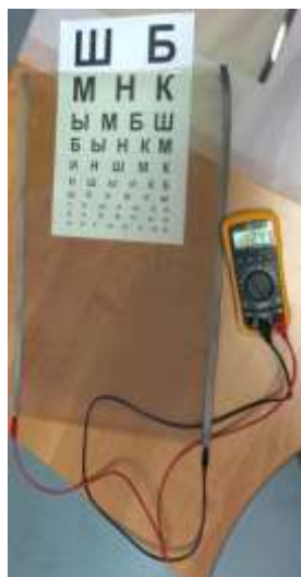
Рис. 8. Образец ПЭТФ-пленки с нанесенным ИТО-покрытием
