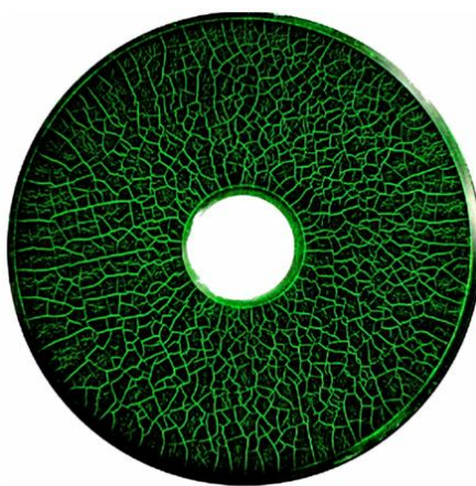
Рис. 1. Эталонный образец типа 1 по ГОСТ Р ИСО 9934-2–2011 [15]
