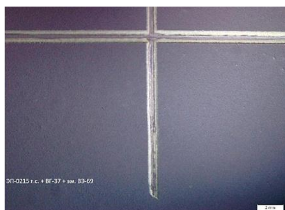
Грунтовка ЭП-0215+грунтовка ВГ-37+эмаль ВЭ-69
