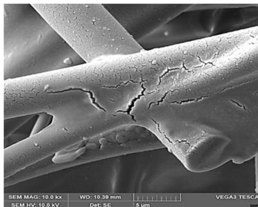
Рис. 8. Микроструктура поверхности образца типа ТЗМК с фторпарафиновым покрытием
