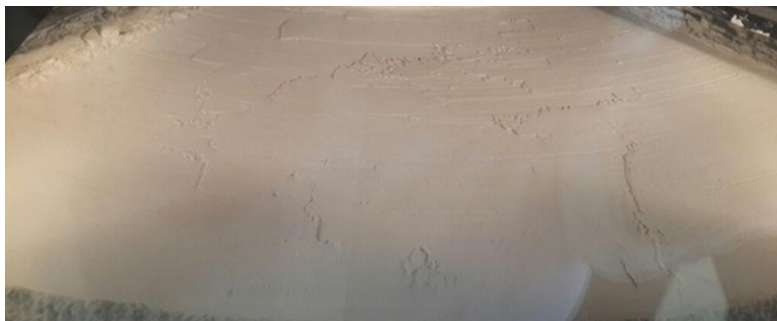
Рис. 1. Комкование порошка полиэфирэфиркетона в камере построения образца
