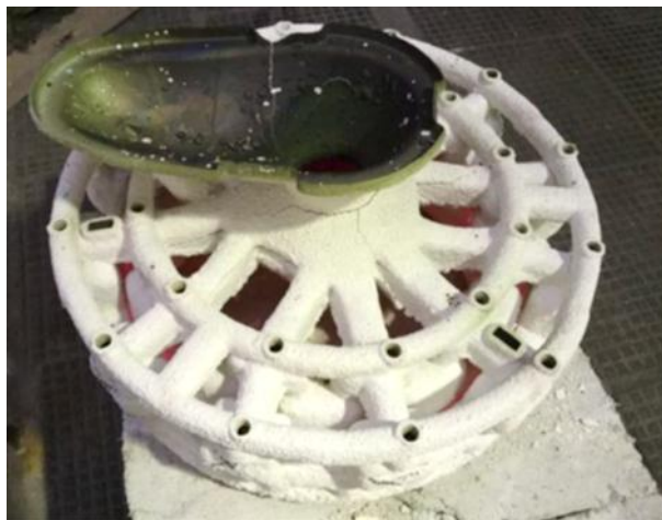
Рис. 7. Общий вид залитой керамической формы
