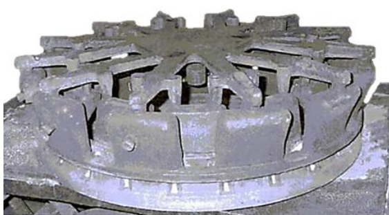
Рис. 8. Общий вид отливки детали типа «диффузор» с элементами литниково-питающей системы
