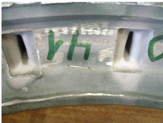
Рис. 10. Общий вид фрагмента отливки типа «диффузор» с удаленным слесарной обработкой дефектом
