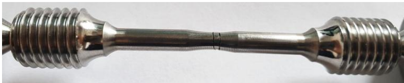
Рис. 6. Характер разрушения образца с корсетной рабочей частью
