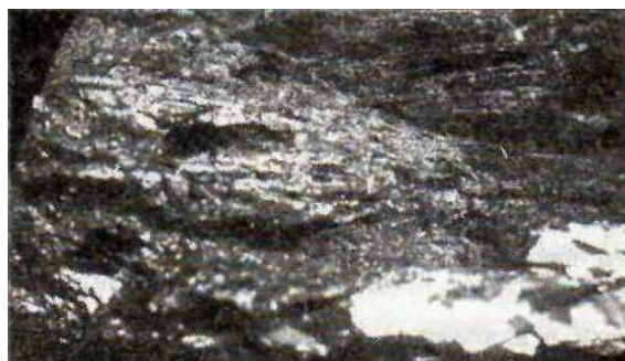
Рис. 3. Интерметаллиды ZrAl_3 в виде пластинок в концентрате ЦАГД (натуральная величина, фрагмент)
