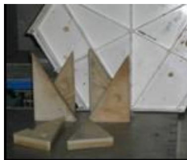
Рис. 3. Фрагменты модельной массы, извлекаемые из фторопластового поддона
