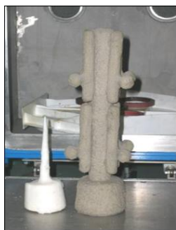
Рис. 2. Вид удаленного модельного состава и оболочковой формы
