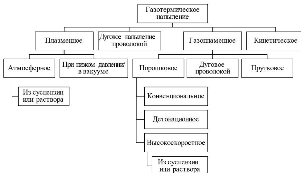
Рис. 1. Классификация методов газотермического напыления [5]
