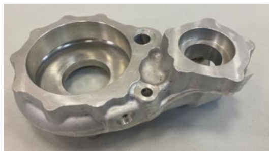
Рис. 2. Внешний вид корпуса компрессорного агрегата
