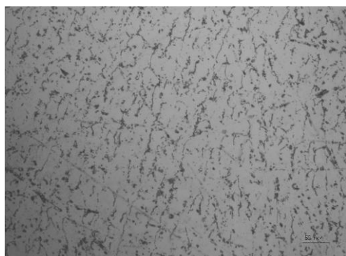
Рис. 12. Микроструктуры ( \times 50 ) наплавленного образца, выполненного лазерной сваркой
