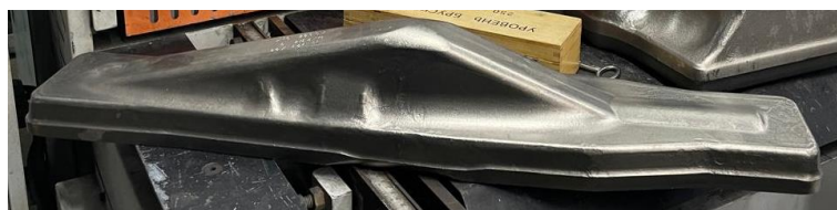
Рис. 1. Общий вид штамповок из сплава ВТ23М, полученных в опытно-промышленных условиях
