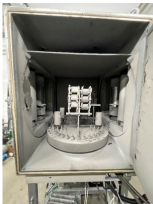
Рис. 2. Размещение имитаторов крупногабаритных деталей газотурбинного двигателя и образцов-свидетелей на приводе вращения обрабатываемых деталей ионно-плазменной установки типа ВИАМ-МЭШ-50
