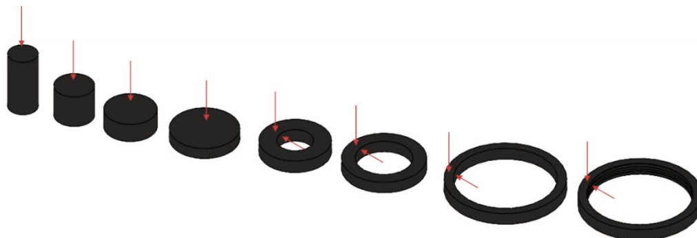
Рис. 1. Изменение внешнего вида исходной заготовки до конечного кольца из сплава марки ВТ46
