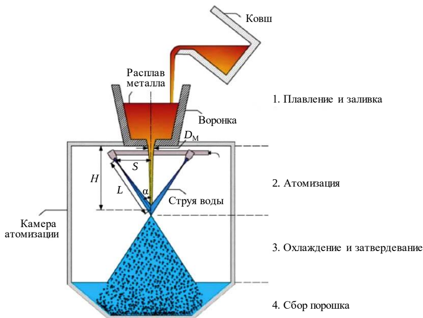
Рис. 3. Схематическое изображение процесса водяной атомизации [16]
