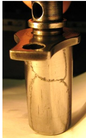
Рис. 9. Цилиндрический контрольный образец с выявленными дефектами
