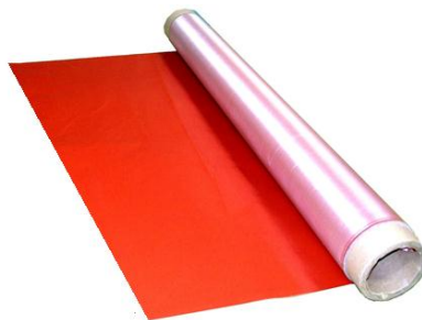
Рис. 2. Внешний вид опытного пожаробезопасного тканепленочного материала
